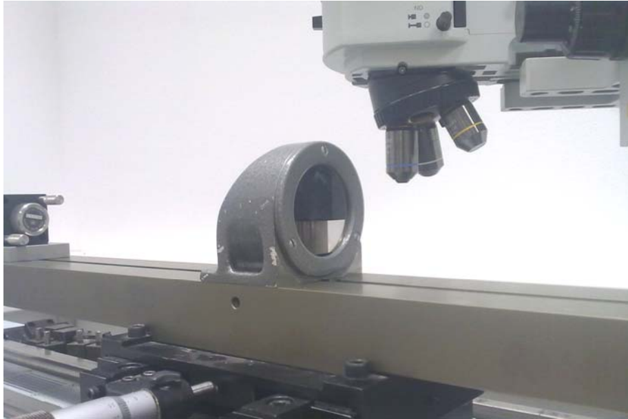
Slika 113. Postavljanje reflektora autokolimatora
