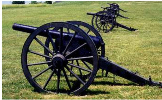
Slika 2.2. Topnička cijev na postolju odnosno lafetu [8]
