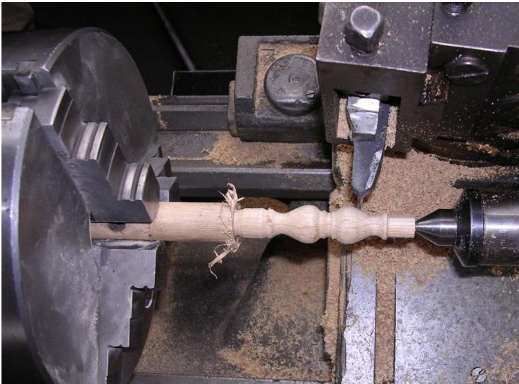
Slika 2.1.6. Oblikovno (kopirno) tokarenje [1].
