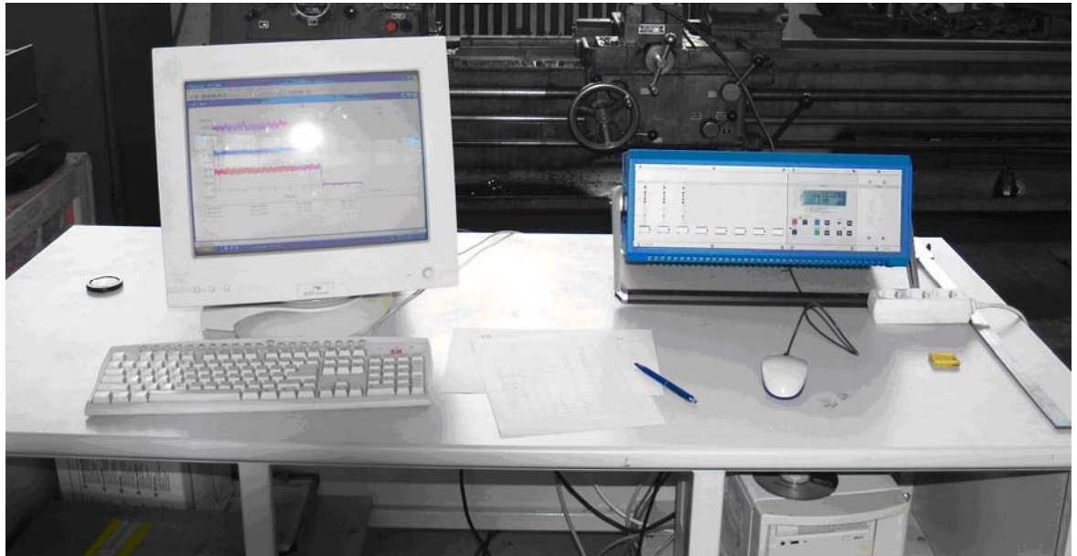
Slika 5.3.4.2. Pojačalo i ekran računala sa izlaznim signalom mjernog uređaja
