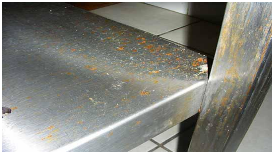
Slika 6. Korozija u kuhinji [10].
