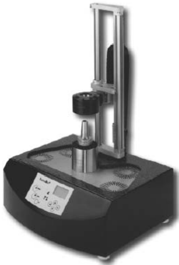
Slika 3.11. Uređaj za zagrijavanje osnovnog držača alata [BHS3200] [11]
