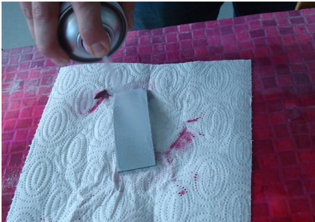
Slika 34. Nanošenje prevelike količine penetranta
