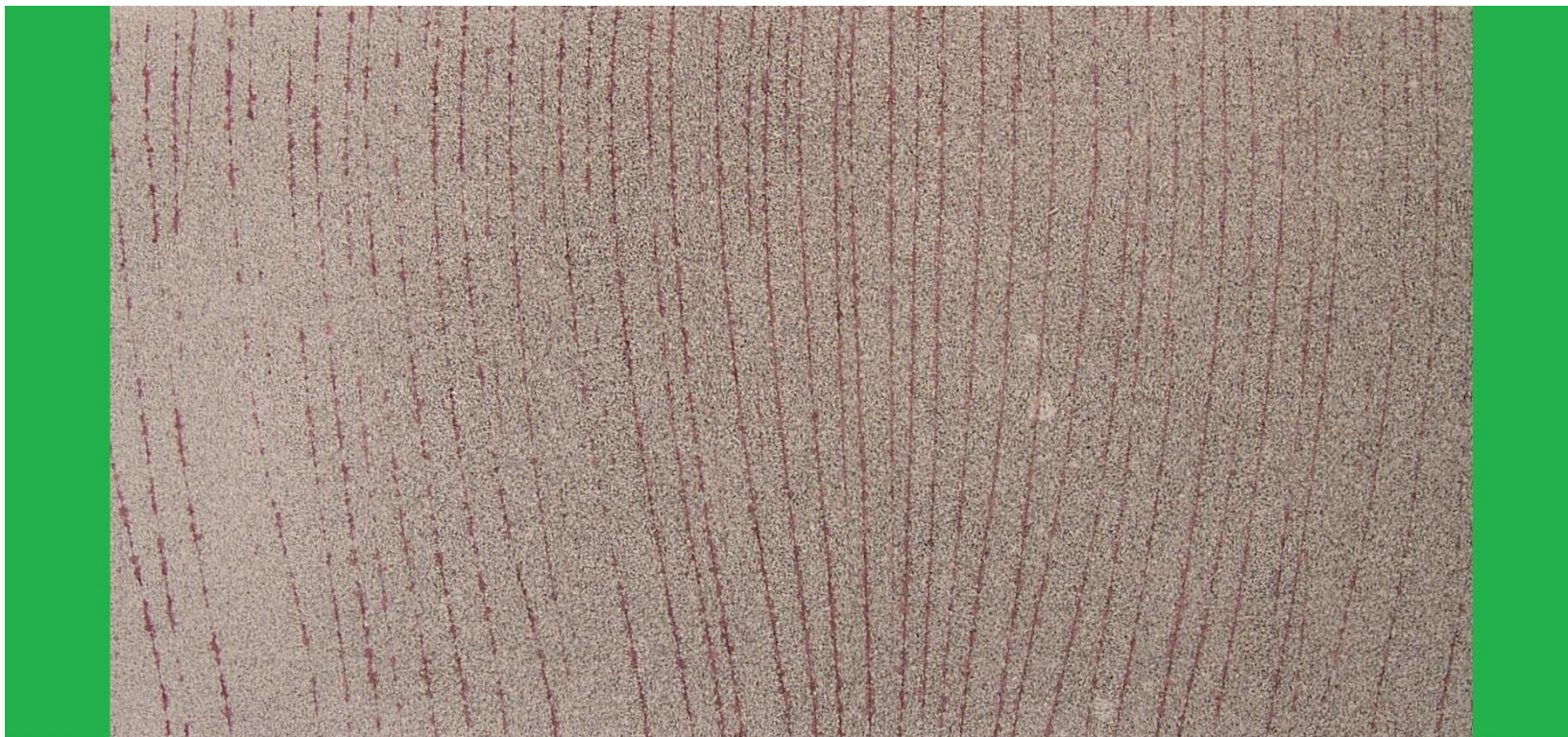
Slika 42. Indikacije na uzorku BSP0188 nakon ispravno provedenog ispitivanja
