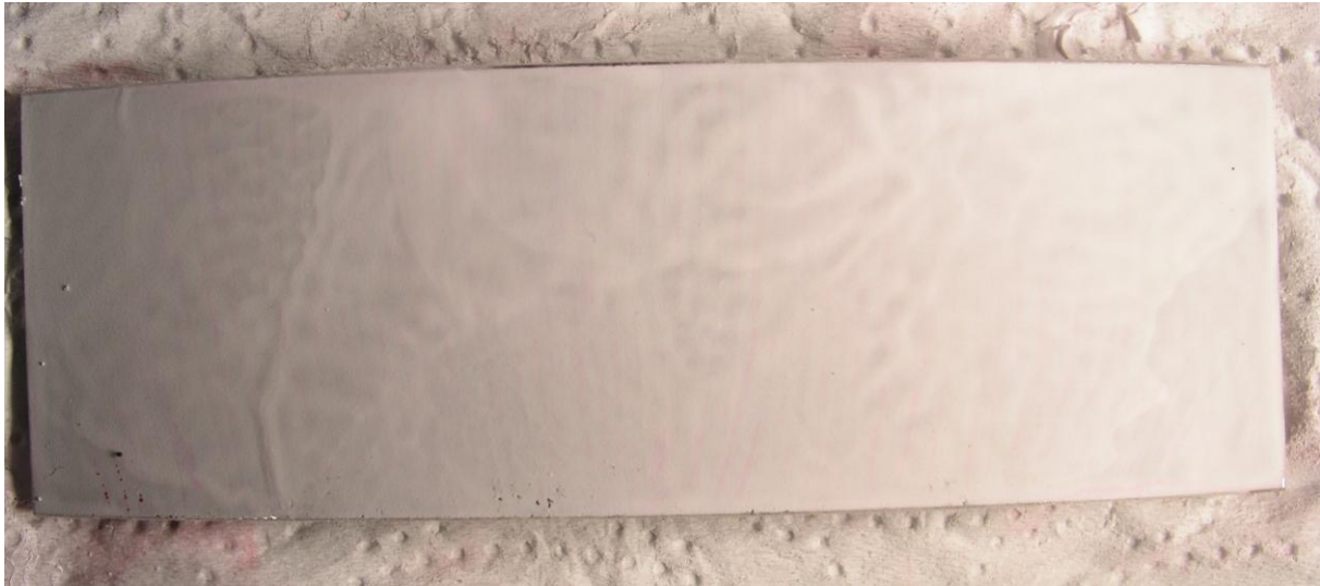
Slika 35. Indikacije uz preveliku količinu razvijlača
