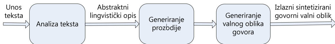
Slika 2. Konverzija teksta u govor prikazan kao analiza-sinteza proces[1]
