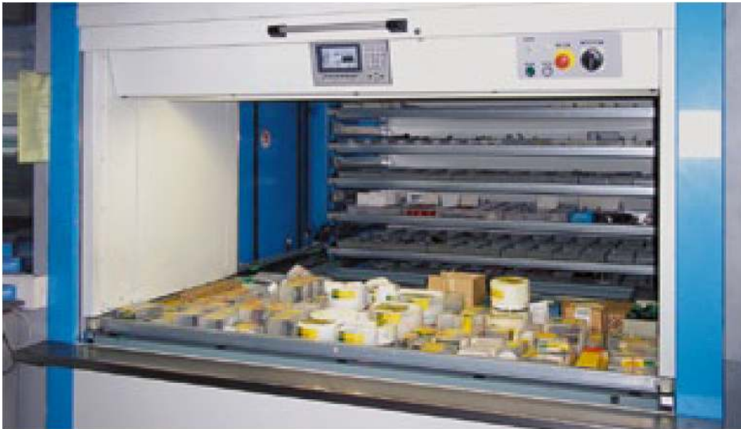
Slika 20. Radni otvor VLM-a s mjernim alatima TEH-CUT-a [9]
