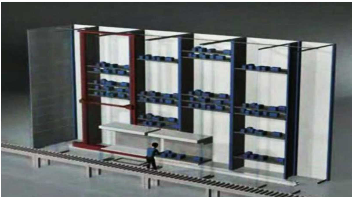
Slika 6. Radna stanica s više modula i jednim dizalom s mogućnošću uzdužnog pomicanja
