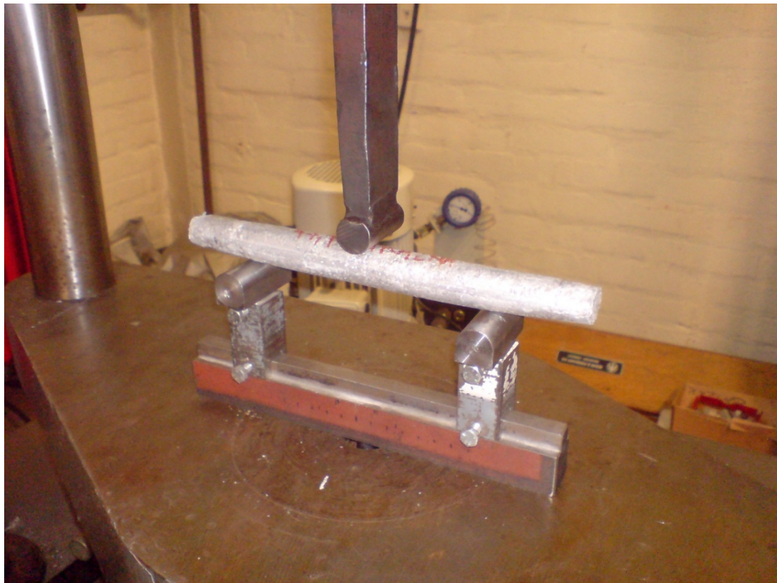
Slika 40. Uzorak na kidalici pripremljen za ispitivanje
