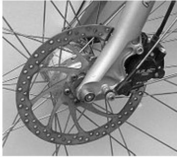
Slika 18. Prednja disketna kočnica montirana na prednju vilicu
