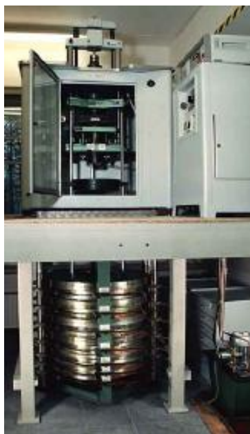
Slika 2.3 Primarni etalon tvrdoće u PTB-u [20]
