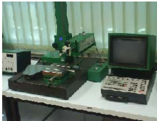
Slika 33. Uređaj za mjerenje topografije PRETHOMETER S8P
