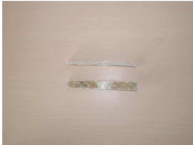
Slika 22. Djelomični lom epruveta bez zareza
