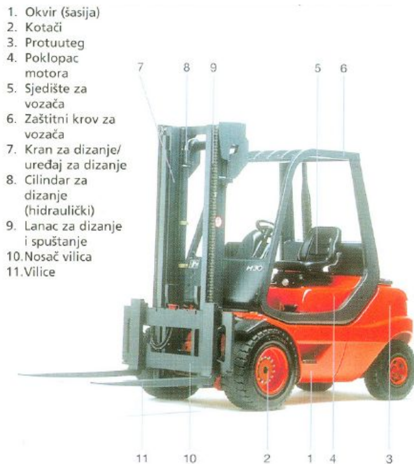
Slika 2.2. Prikaz glavnih dijelova viličara (čelna izvedba) [2]
