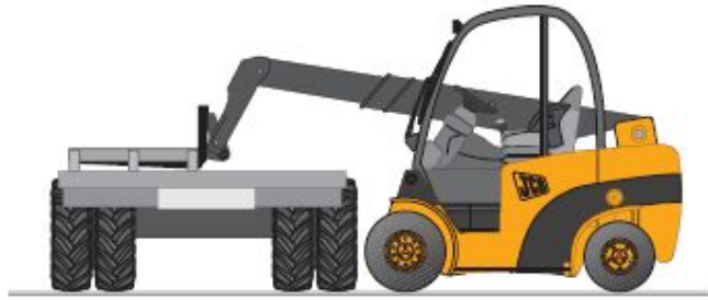
Slika 2.9. Dohvat palete sa teretnog vozila (teleskopski viličar)
