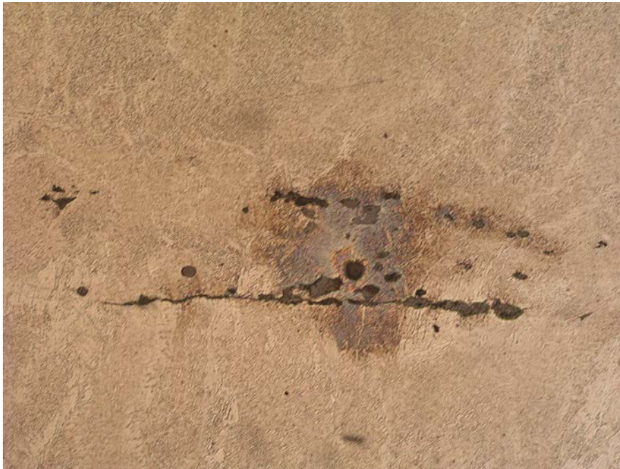
Slika 4.42 Duguljasti silikatni uključak kao inicijacija pukotine –uzorak F125, povećanje 500x, polirano stanje
