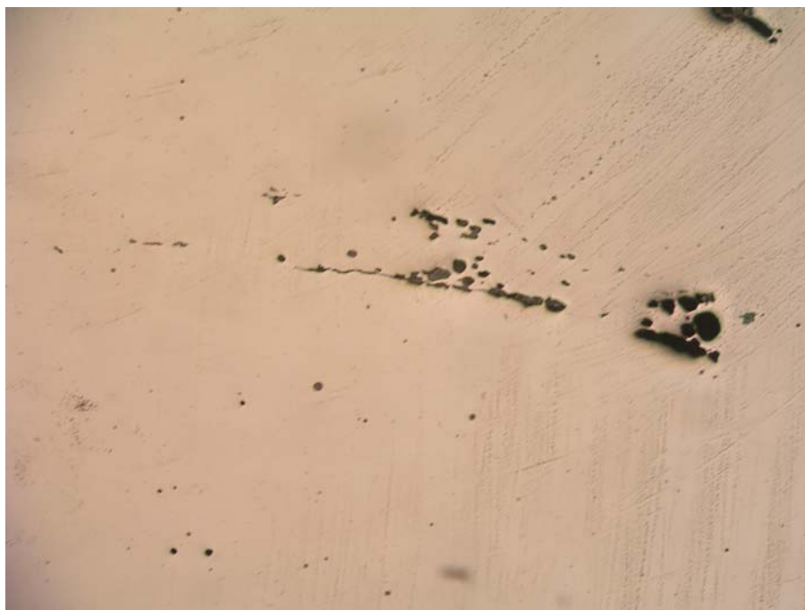
Slika 4.44 Niz uključaka u metalu zavara- uzorak F135, povećanje 50x, polirano stanje
