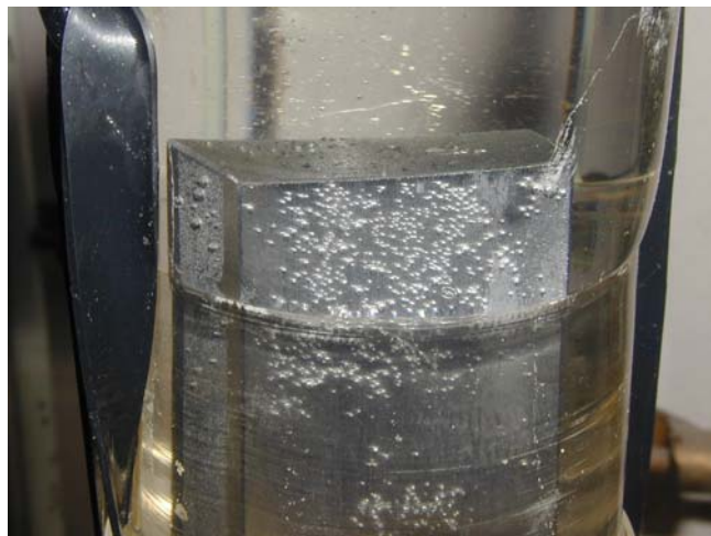
Slika 3.10 Izlučivanje mjehurića vodika iz uzorka
