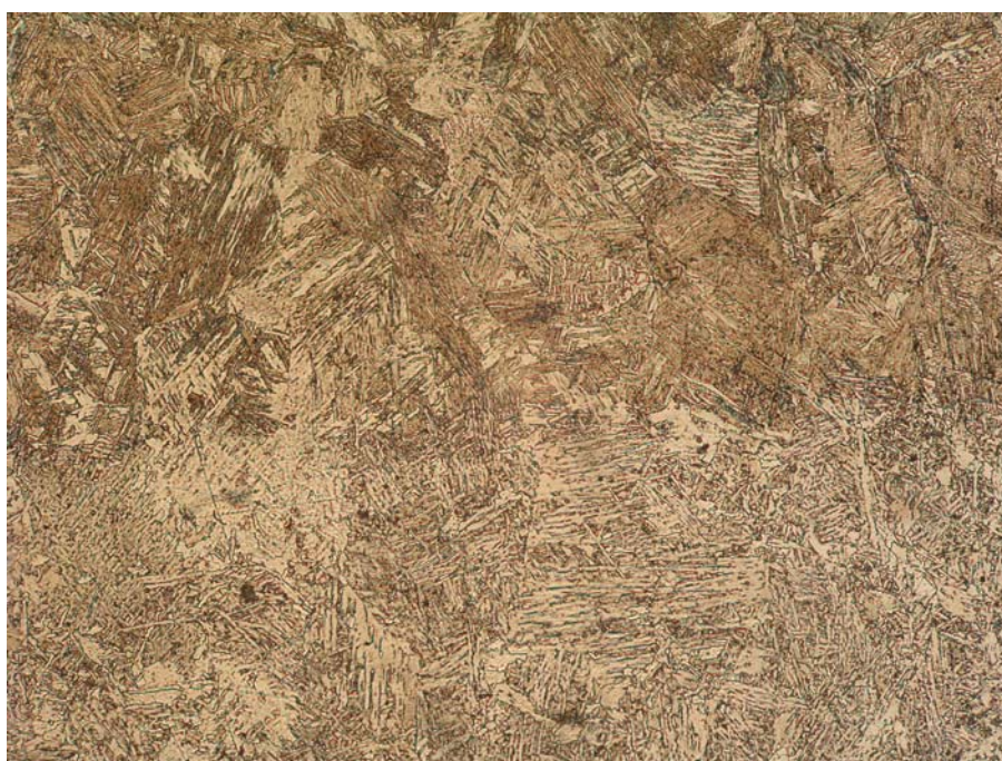
Slika 4.37 Linija staljivanja –uzorak IB21, povećanje 200x
