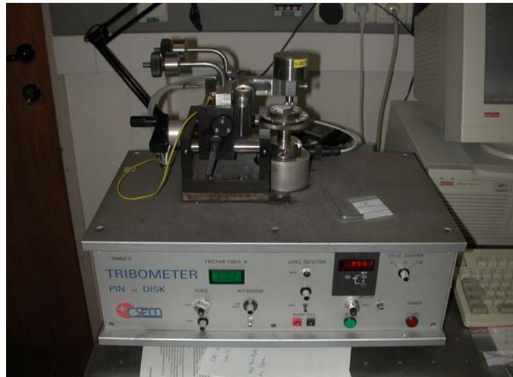
Slika 5.53. CSEM tribometer - TRIBO II
