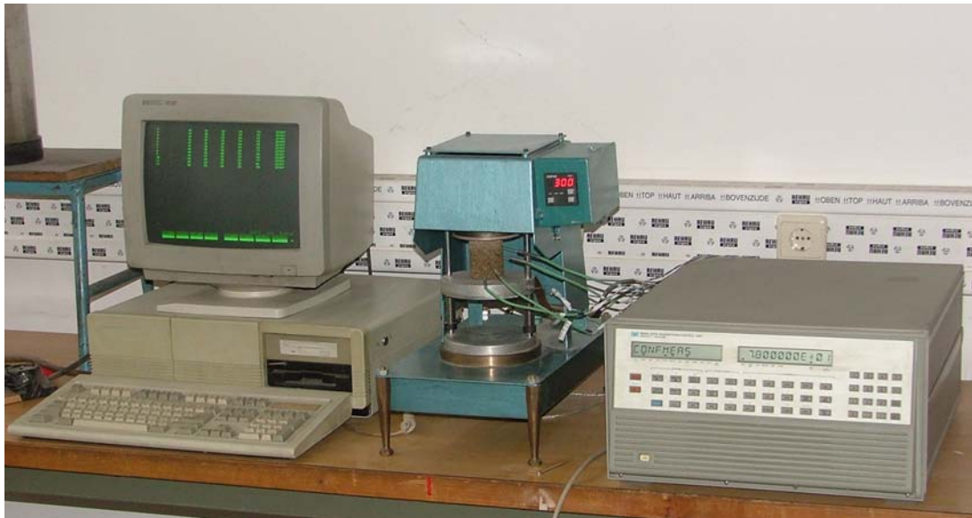
Slika 6.6 Mjerna oprema za eksperimentalno određivanje koeficijenta toplinske vodljivosti
