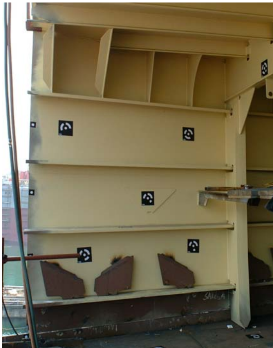
Slika 104: Mjerne točke na sekcijama svjetlog otvora
