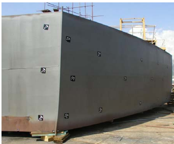
Slika 69: Postavljanje mjernih točaka na sekciji
