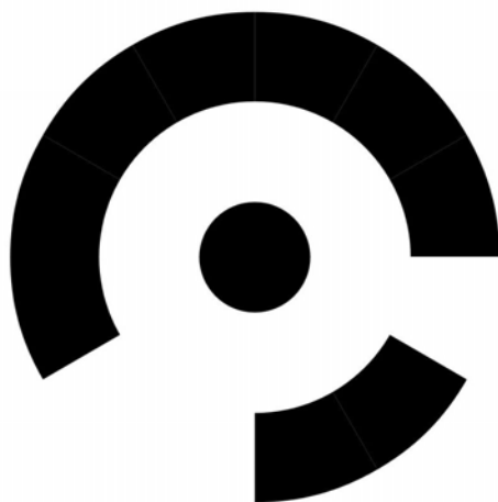
Slika 38: Kodirana mjerna točka
