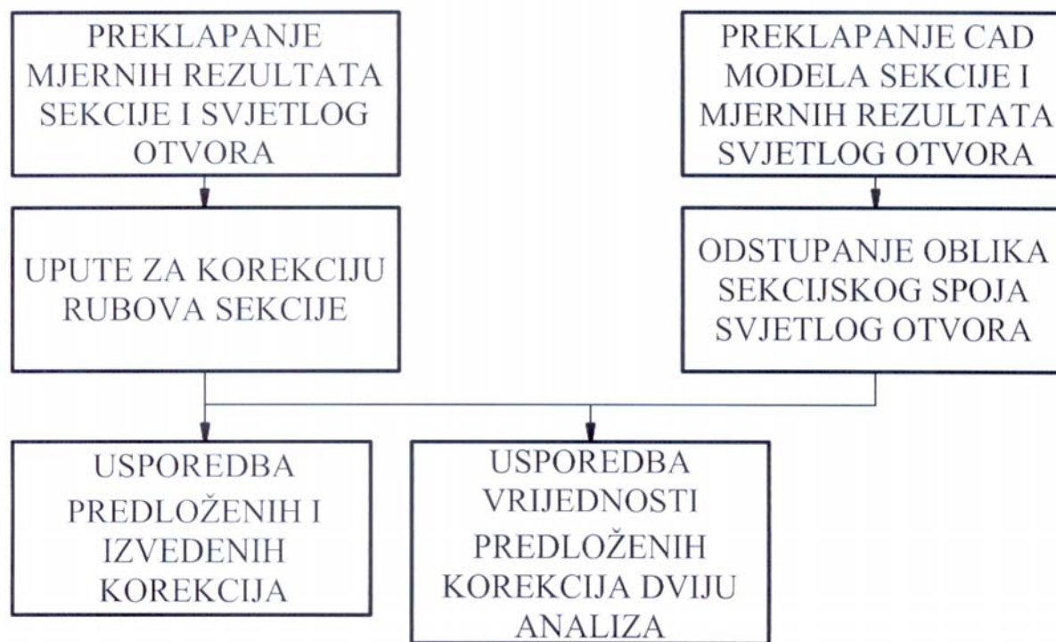
Slika 95: Dijagram toka analize mjernih rezultata pri montaži sekcija
