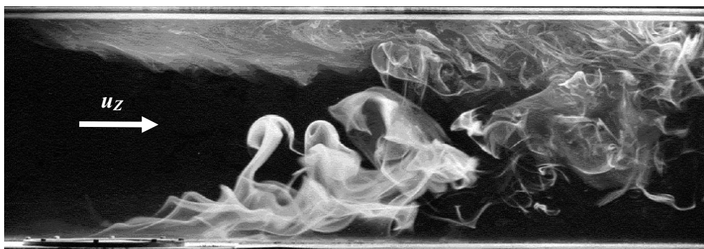
Foto 10: Prikaz širenja dima ostvaren prilikom neizotermnih modelskih ispitivanja [62] ( u_z < u_c , toplinska snaga izvora Q = 15 \text{ kW} )
