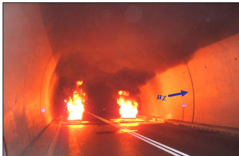
Foto 7: Razvoj stratifikacije dima u početnoj fazi požarnog testa, u_z = 0,7 m/s
