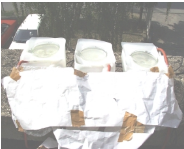
Slika 15. Fotografija detalja eksperimentalnog sustava za vrijeme odvijanja eksperimenta – reaktori s termostatirajućim posudama
