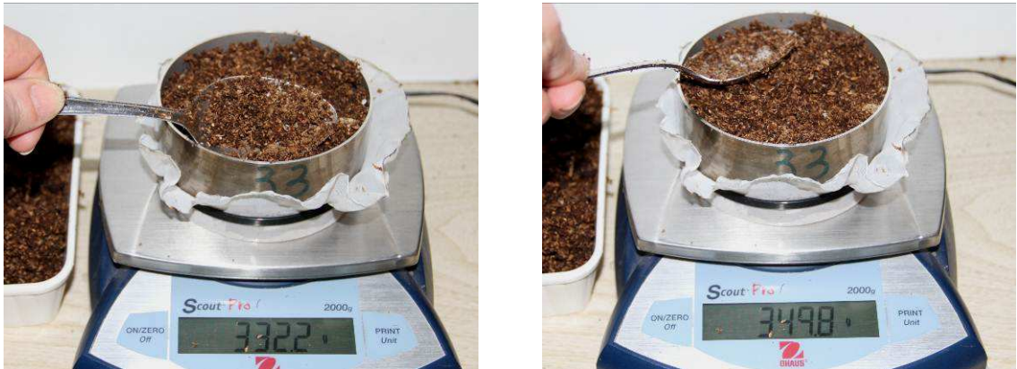
Fig 1: Llenado de los cilindros y distribución homogénea del sustrato por capas con la ayuda de una cuchara
