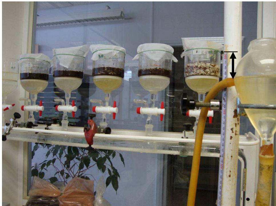
Fig 2: Segunda batería de 6 embudos usados para realizar las mediciones. Las flechas indican se está tensionando a 5 hPa (5 cm desde la base de la placa hasta el nivel del agua del balón)
