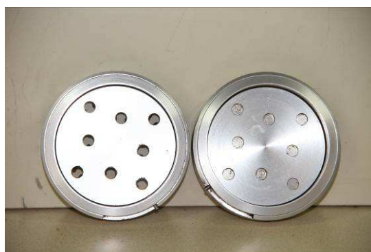
Fig 2 : Porómetros ya armados y tapas (foto izquierda) y detalle de los platos base con los 8 orificios en posición abierta o cerrada (foto derecha)
