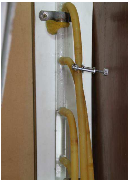
Fig 6: Detalles del sistema de drenaje: Distribuidor de vidrio abierto en 30 hPa de tensión mediante abertura de la válvula correspondiente (foto izquierda) y unión de la manguera con en distribuidor de vidrio ( foto derecha)
