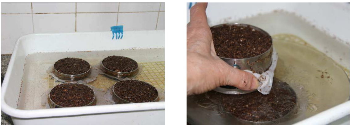
Fig 2: Cilindros en el baño de saturación (foto izquierda) y retiro del baño apoyando el cilindro en un plato (foto derecha)
