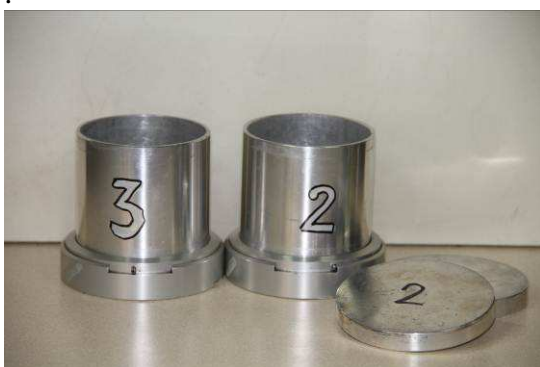
Fig 2 : Porómetros ya armados y tapas (foto izquierda) y detalle de los platos base con los 8 orificios en posición abierta o cerrada (foto derecha)
