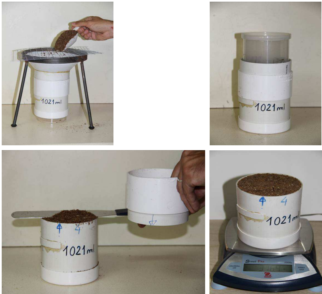
Fig 2: Procedimiento: Foto superior izquierda, llenado del aparato con tamiz controlador de caída y el trípode. Foto superior derecha: aparato con el pistón compactador. Foto inferior izquierda: enrasado del material compactado. Foto inferior derecha: pesada del material
