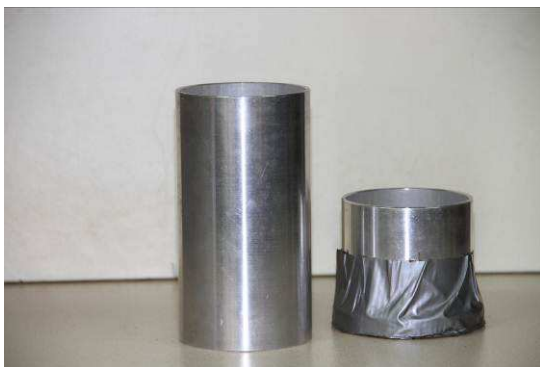
Fig 1: Columna de 15cm de altura y cilindro con tapa pegada en la base (foto izquierda) y cilindros, bases y tapas que forman el porómetro (foto derecha)
