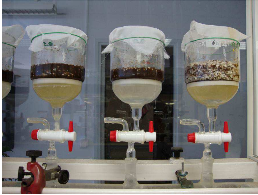
Fig 3 : Embudos de tensión con parte superior cilíndrica donde va alojado el sustrato y parte inferior cóncava llena de agua . Se aprecia el detalle de la válvula de 3 vías.
