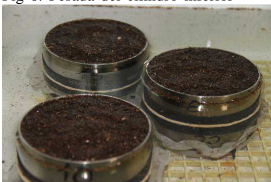
Fig 8: Cilindros con sustrato saturado después de 24 h
