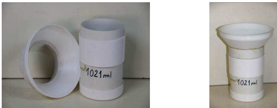
Fig 1: Sucesivos pasos para armar el conjunto de aparato compuesto de: cilindro portamuestra (1), collar desmontable (2), anillo sujetador (3) y embudo (4)
