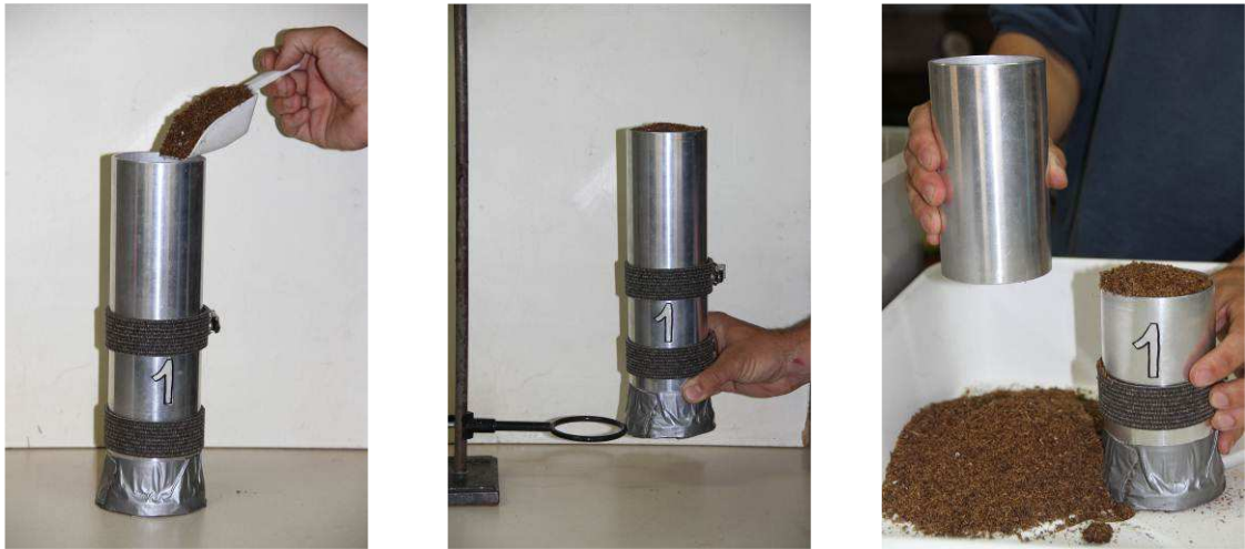
Fig 3: Llenado del conjunto para compactación (foto izquierda), caída desde 6 cm de altura por 5 veces (foto centro) y retirada de la columna de 15 cm (foto derecha)
