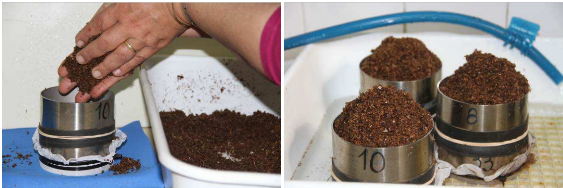
Fig 2: Llenado de los cilindros con material suelto (foto izquierda) y cilindros durante el llenado del baño de saturación (foto derecha)
