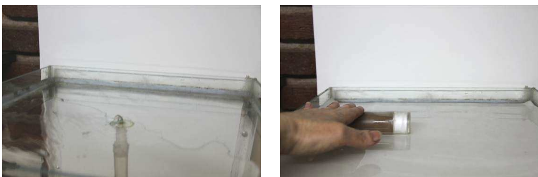
Fig 7: Purgado del sistema de drenaje con agua (foto izquierda) y compresión con rolo para retirar el aire entre el vidrio y el papel de filtro (foto derecha)
