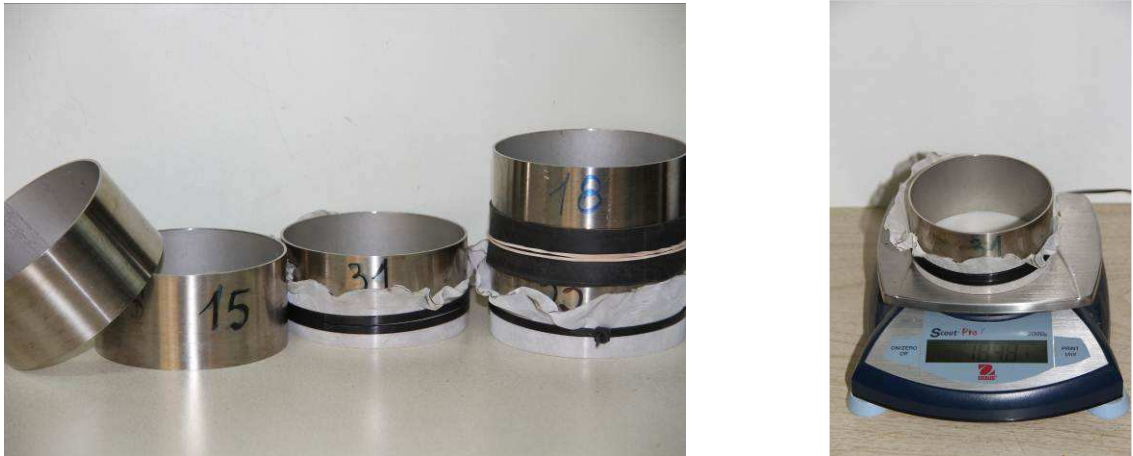
Fig. 1: Cilindros portamuestras, pesada del cilindro inferior armado y conjunto de los 2 cilindros superpuestos
