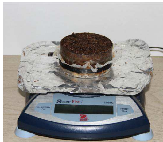
Fig 10: Pesada del cilindro inferior con sustrato a 10 hPa
