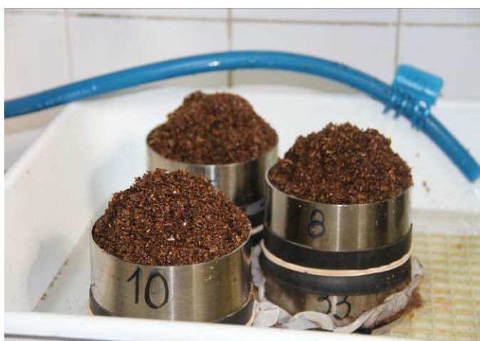
Fig 7: Llenado del baño de saturación
