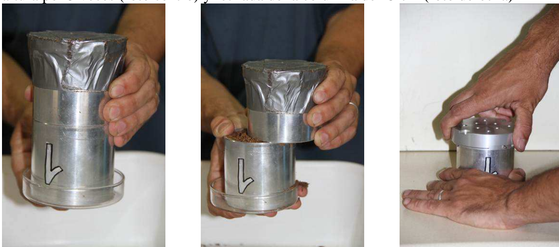
Fig 4: Cilindro dado vuelta sobre el petri (foto izquierda), retiro del cilindro con tapa pegada (foto centro) y ajuste del plato base del porómetro (foto derecha)
