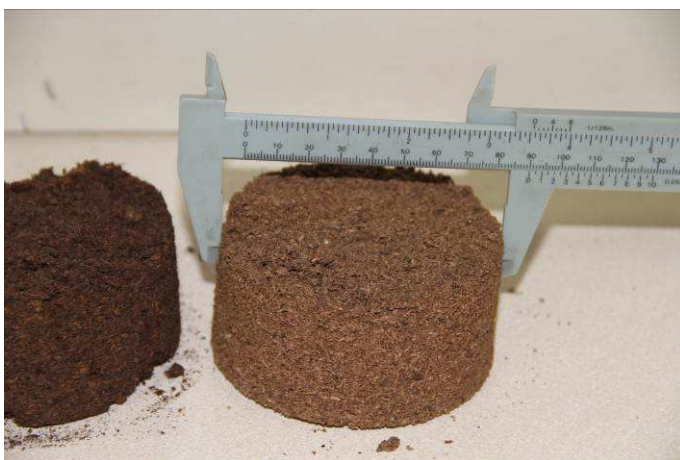
Fig 14: Medidas de las altura y diámetros para calcular el nuevo volumen obtenido
