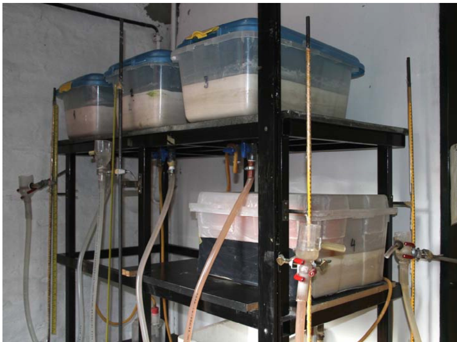
Fig 3: Equipos tipo lecho de arena. Los 3 del estante superior se utilizan para tensionar hasta 100 hPa y el del estante inferior para tensionar los tubos a 50 hPa.
