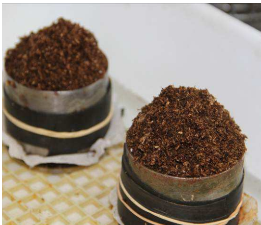
Fig 4: Llenado del baño de saturación
