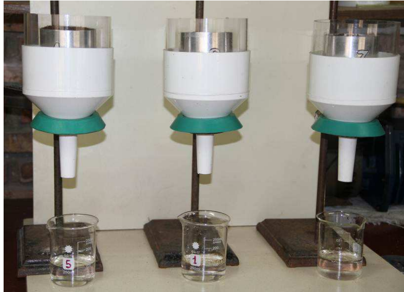
Fig 6 : Drenaje libre (1 hora) y colecta del liquido drenado en las 3 repeticiones
