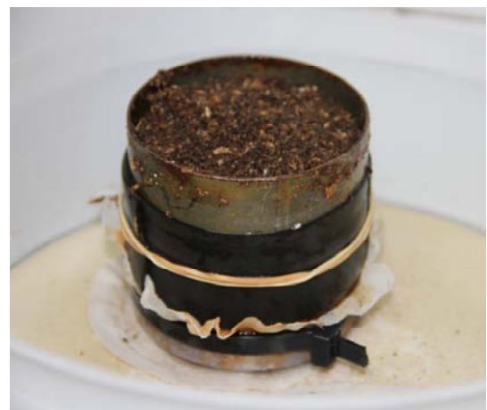
Fig 7: Colocación sobre el lecho de arena
