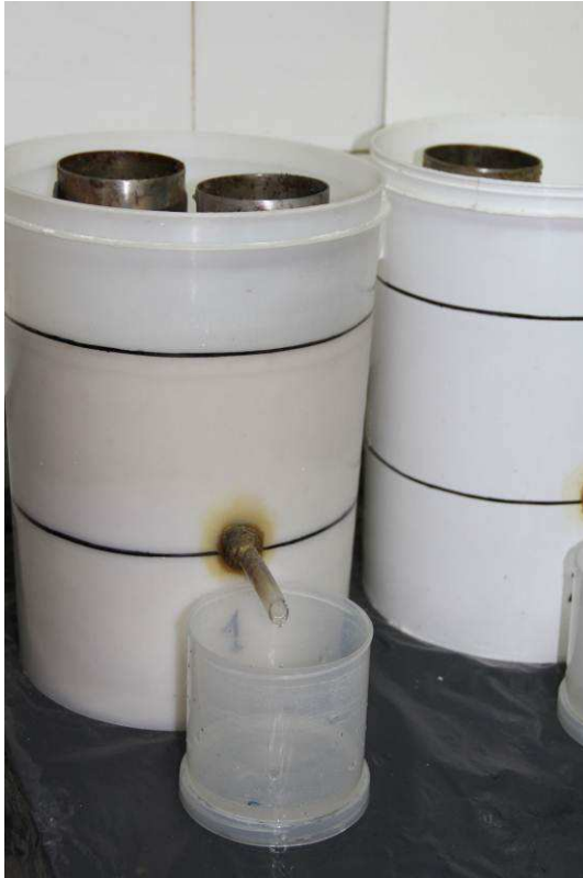
Fig 8 : Cilindros con sustrato a 10 hPa cuando cesa de gotear ( 24-48 h)
