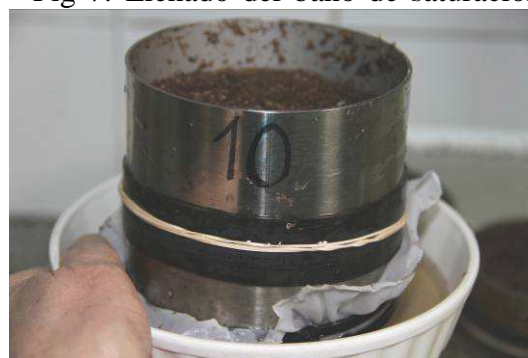
Fig 9: Transferencia al lecho de arena
