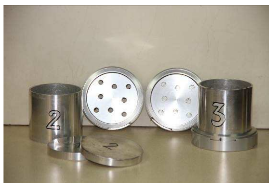
Fig 1: Columna de 15cm de altura y cilindro con tapa pegada en la base (foto izquierda) y cilindros, bases y tapas que forman el porómetro (foto derecha)
