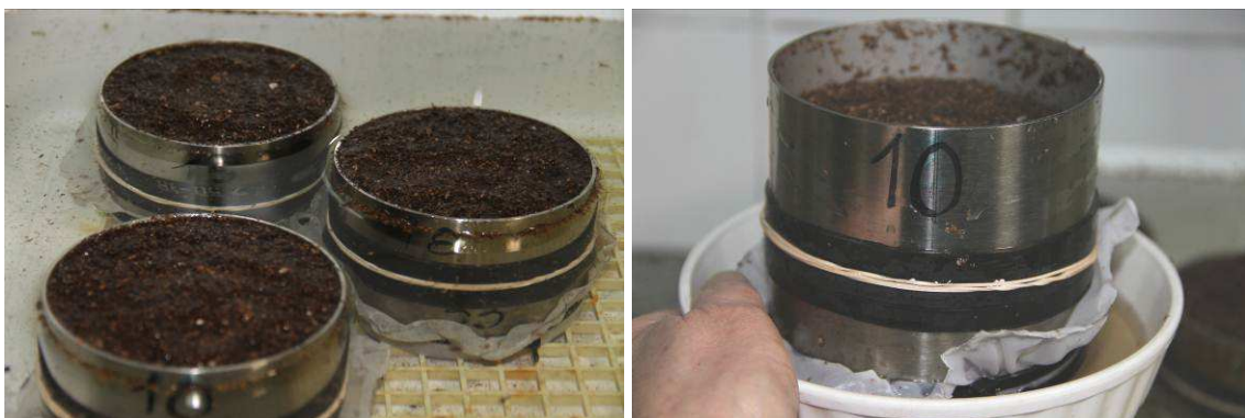
Fig 3: Cilindros en el baño de agua a 1 cm del borde superior después de 24-48 h con el material saturado (foto izquierda) y retiro del cilindro para colocarlo en el embudo de yeso
