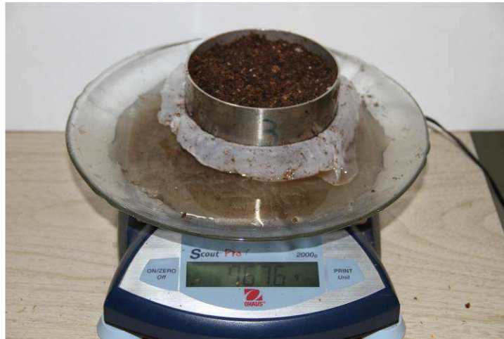
Fig 3: Pesada del cilindro saturado con el plato que retiene el agua de drenaje rápida
