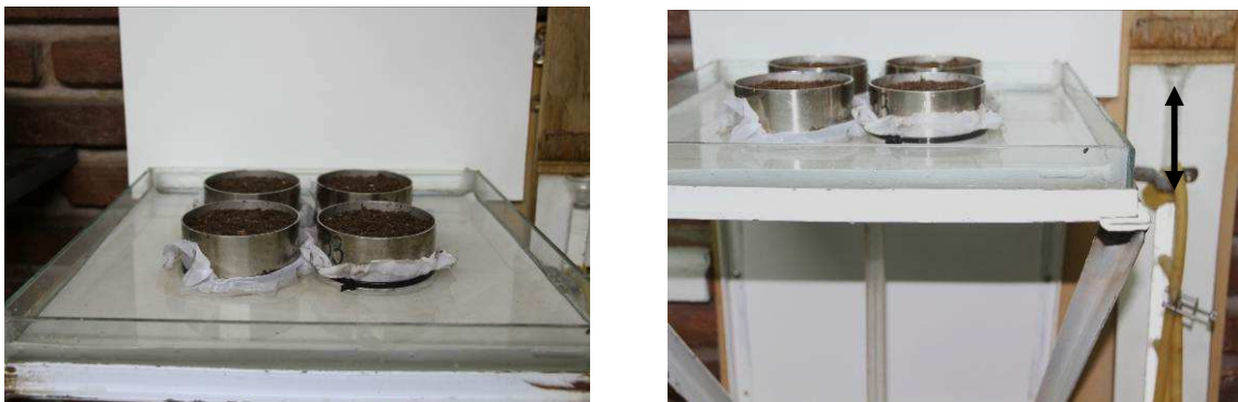
Fig 4: Colocación de los cilindros sobre el papel de filtro (foto izquierda) y aplicación de tensión de 10 hPa mediante la abertura de la primer válvula. La flecha indica los 10 cm desde la mitad del cilindro hasta la salida del drenaje (foto derecha).
