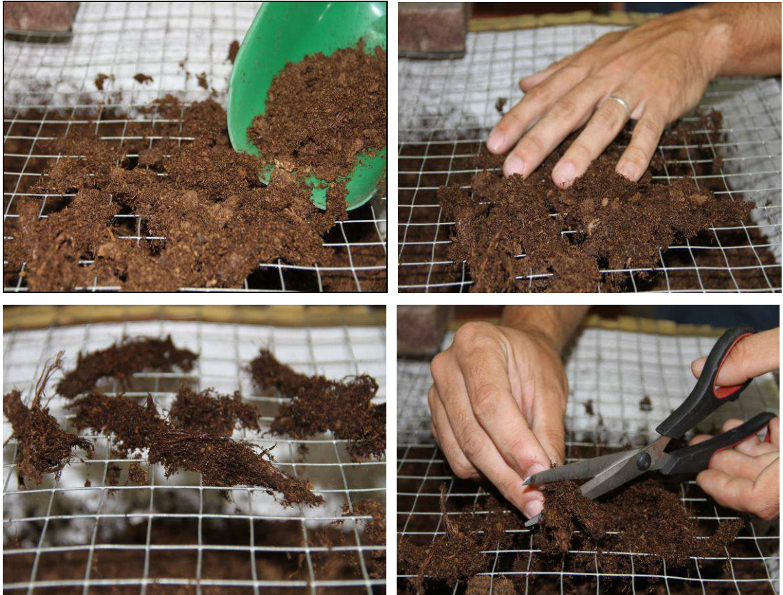
Fig. 1: Procedimiento 5.3: pasaje de la muestra a través del tamiz y corte de las partículas que quedan retenidas en el tamiz
