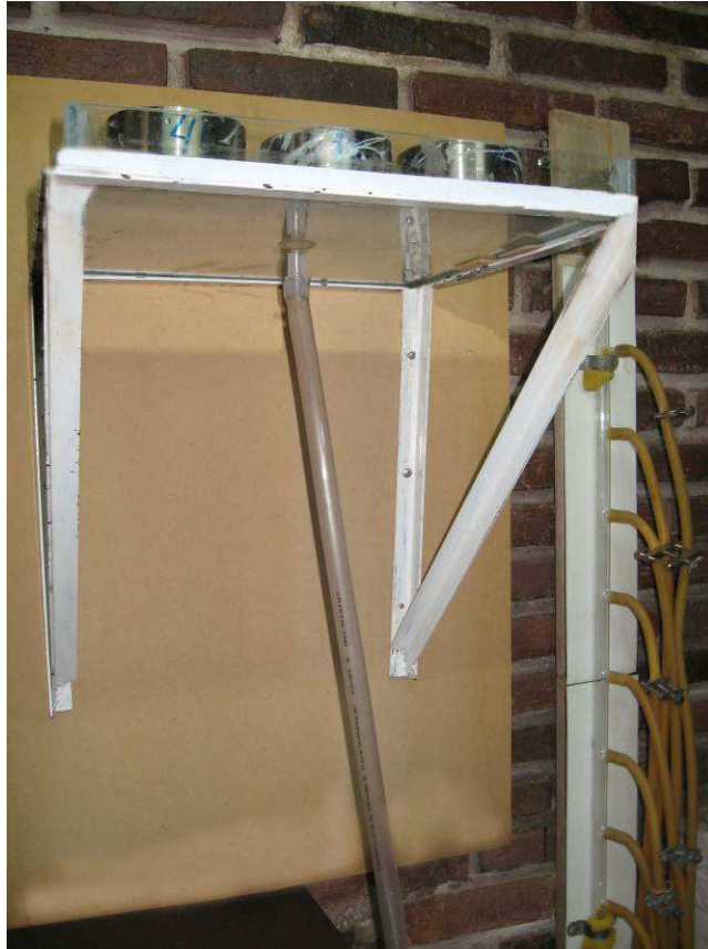
Fig 5: Mesa de tensión de vidrio con papel de filtro y distribuidor de vidrio, colocados con soporte a 1,80 m de altura
