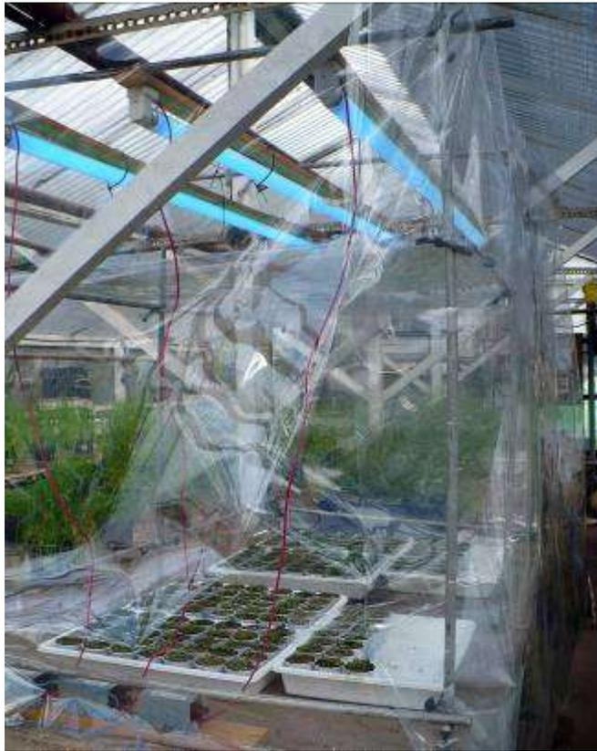
**Figura 3:** Arreglo de lámparas para los experimentos de suplementación con UV-B en el invernáculo.
