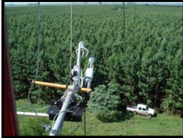
*Figura 3.1.13: Torre micrometeorológica en la provincia de Corrientes. En la parte central se observa a la derecha el analizador infrarrojo de gases y a la izquierda del mismo el anemómetro sónico.*
