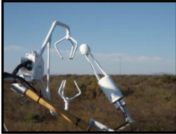
*Figura 3.1.7: Torre micrometeorológica en la provincia de San Luis. Se observa a la derecha el analizador infrarrojo de gases y a la izquierda el anemómetro sónico.*
