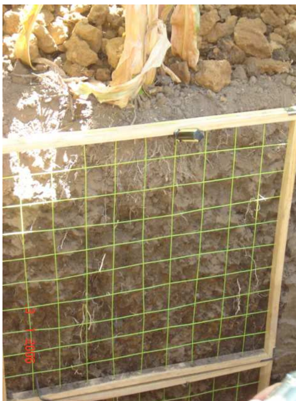
Foto 4.2. Calicata para cuantificación de abundancia de raíces por el método de la cuadrícula.
