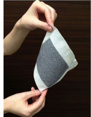
Abbildung 24: Eingewebte Solarzellen stellen eine Möglichkeit für die Stromversorgung von Smart Cloths dar. [25]
