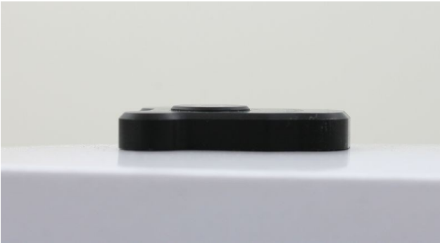
Abbildung 56: Die leichte Erhöhung deckt die drucksensible Stelle des Sensors ab.
