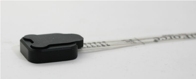
Abbildung 58: So vorbereitet kann der Sensor an die Unterseite der Sohle angebracht werden.
