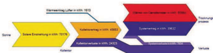
Abb. 3.2-10: Energieflüsse der Pilotanlage im Sankeydiagramm. Energiedaten von April bis einschließlich September 2011
