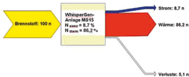
Abb. 3.5-7: Sankey-Diagramm unter Annahme der im Feldtest ermittelten maximalen Nutzungsgrade der best-practise-Anlage MS15\_W
