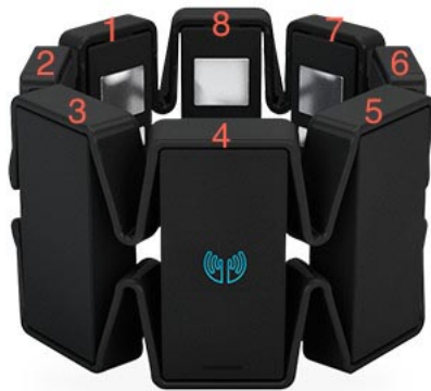
Abbildung 4.2: Reihenfolge der Sensoren und Ursprung der EMG-Daten. 21
