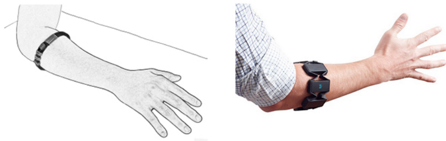
Abbildung 2.3: Links das erste Konzept von einem Armband, das mit EMG-Sensoren ausgestattet ist und am Unterarm getragen werden sollte. Rechts das Thalmic Myo-Armband. 4
