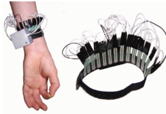
Abbildung 2.9: Das WristFlex verwendet statt EMG FSR-Sensoren. 11
