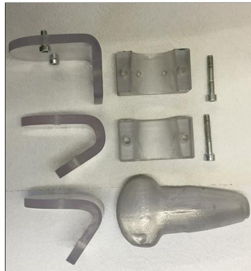
(b) Ultraschallkopfdummy und alle Montagebauteile: links die selbstgebaute Zwischenstücke, rechts die Ausgangsbauteile
