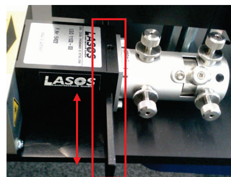
Abbildung 72: Der Filterstab □ ist direkt hinter dem Lasershutter an der Quelle integriert
