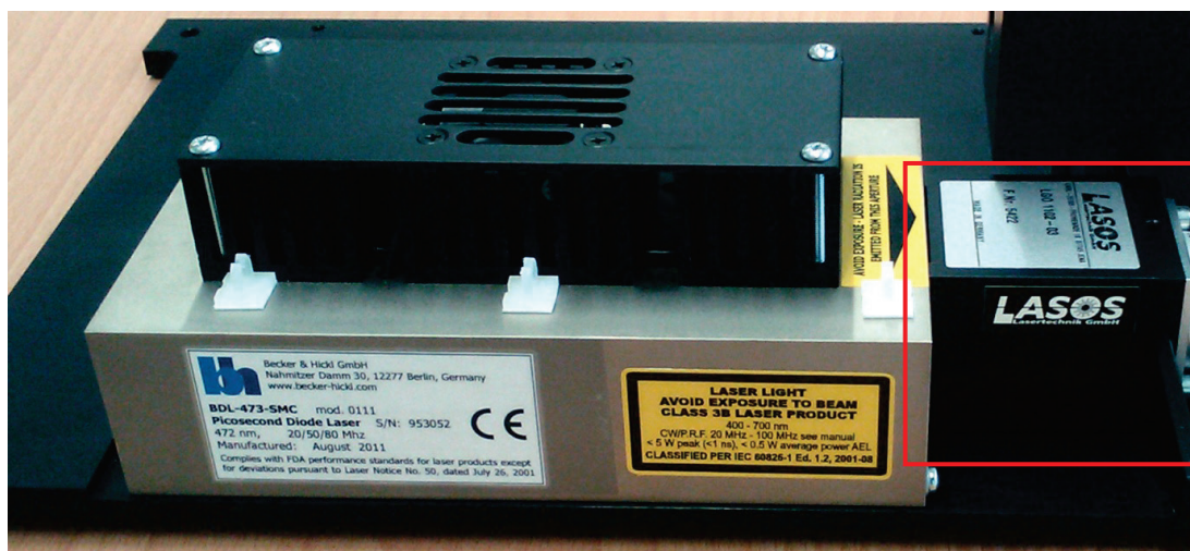
Abbildung 13: Picosekundenlaser, der bei 473 nm emittiert mit einer Wiederholfrequenz von 80 MHz, und Shutter (rechts), der ausschließlich während einer Messung geöffnet ist und sich beispielsweise im Falle einer Sicherheitsabschaltung unverzüglich zum Schutz des Patienten und des Geräts schließt □
