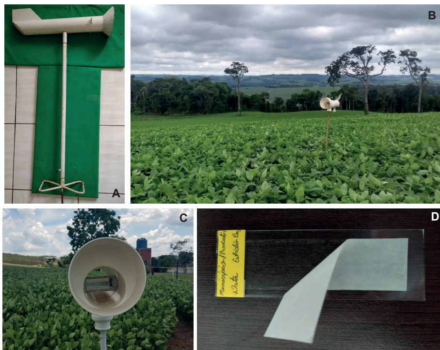
Figura 2. Visão geral do coletor de esporos (A); aspecto do coletor na lavoura (B); tubo visto de frente mostrando o suporte com a lâmina de vidro acoplada (C); lâmina de vidro com a fita dupla face (com a proteção superior parcialmente retirada) e etiqueta com identificação (D).
