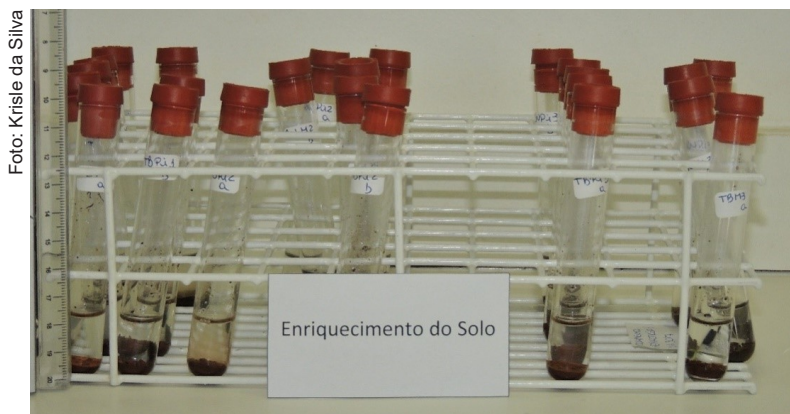
Figura 1. Tubos de ensaio contendo o meio M2 + amostras de solos com 20% de metano.
