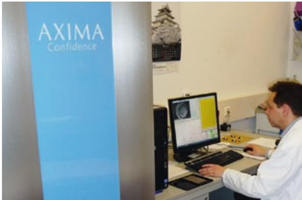
Abb. 1 | Proteinidentifizierung über den „Peptide Mass Fingerprint“ mit einem Shimadzu Axima Confidence MALDI-TOF Massenspektrometer
