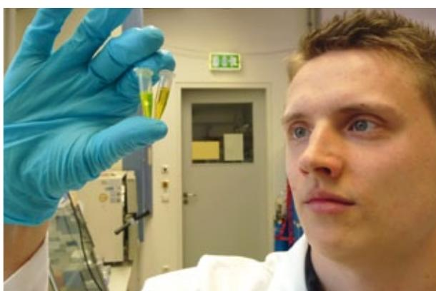
Abb. 1 | Nachweisverfahren für Pflanzenschadorganismen mittels LAMP. Die leuchtend grüne Probe zeigt den Nachweis der Erreger an; rechts die Negativprobe. Unter UV-Licht würde der Effekt deutlich verstärkt werden.
