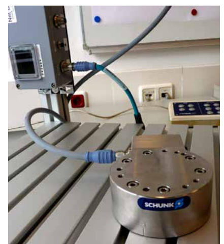
Abb. 6) Foto des Kraftmessensors FT-Omega85.
