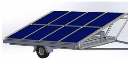
Abb. 7) CAD-Modell der mobilen Photovoltaikanlage
