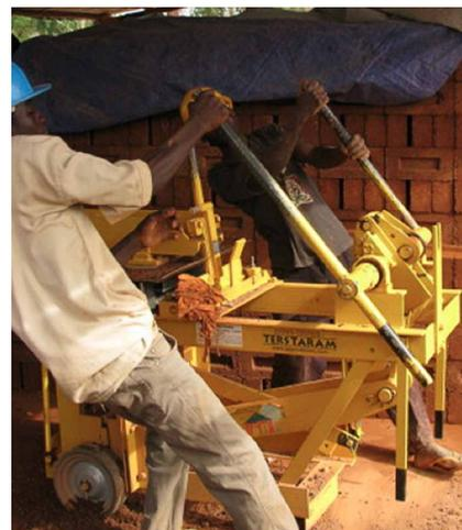
Abb. 5) Togoische Bauarbeiter bei der Bedienung einer manuellen Lehmsteinpresse vom Typ ApproTechno Terstaram [DAZ e.V. 2013]
