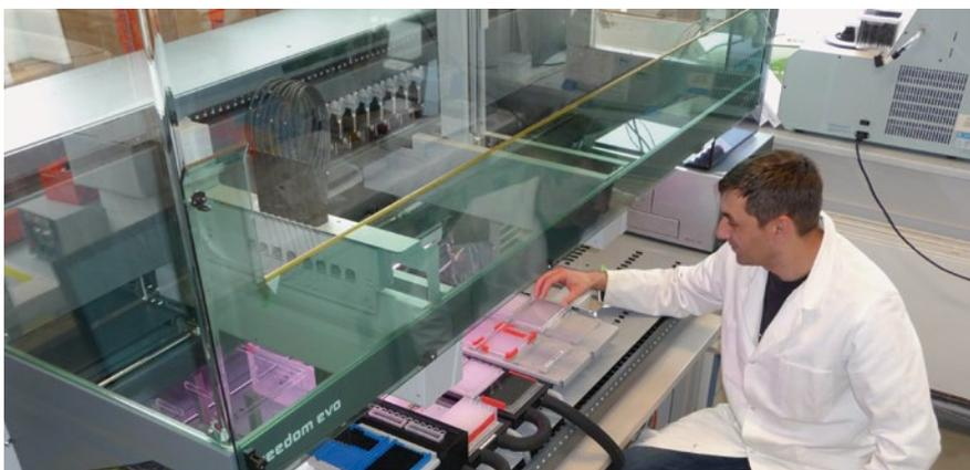
Abb. 1) Pipettierroboter mit Analytik (rechts vom Mitarbeiter)
