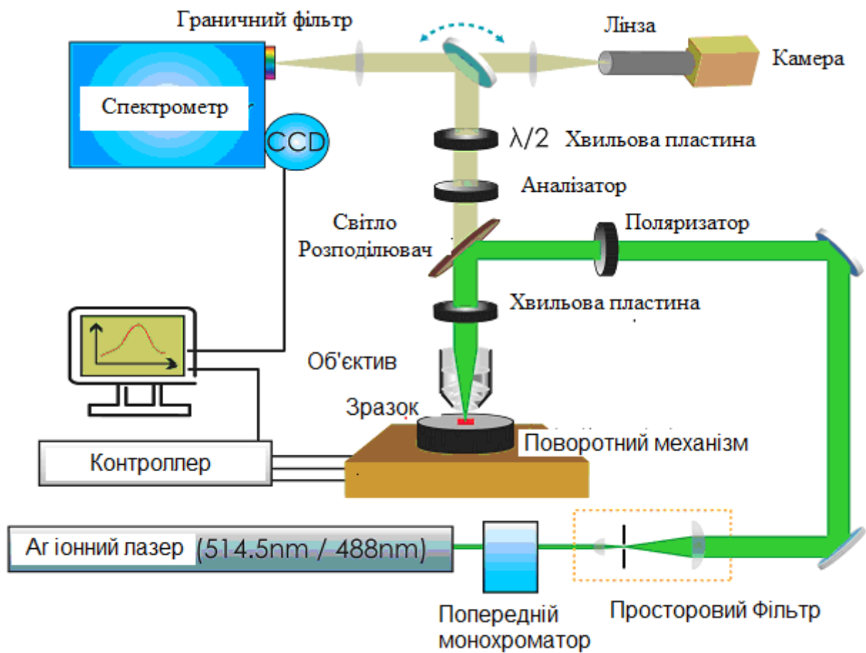
Рисунок 2.4 - Принципова схема пристрою, що використовувався для вимірювання спектрів раманівського розсіювання плівок
