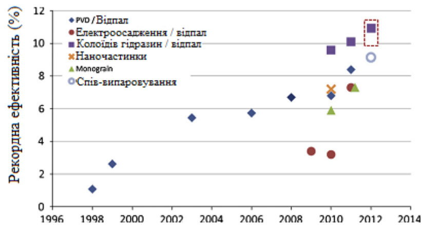
Рисунок 1.11 - Еволюція рекордної ефективності СЕ на основі поглинаючих шарів CZTS виготовлених з використанням різних технологічних процесів
