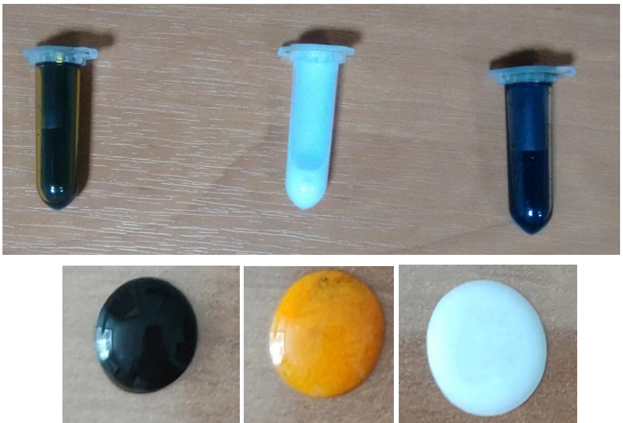
Рисунок 2.3 - Щойно синтезований розчин НЧ CZTS, ZnO, CZTSe після заміщення поверхнево-активних речовин та краплі чорнил CZTS, CdS, ZnO на підкладці
