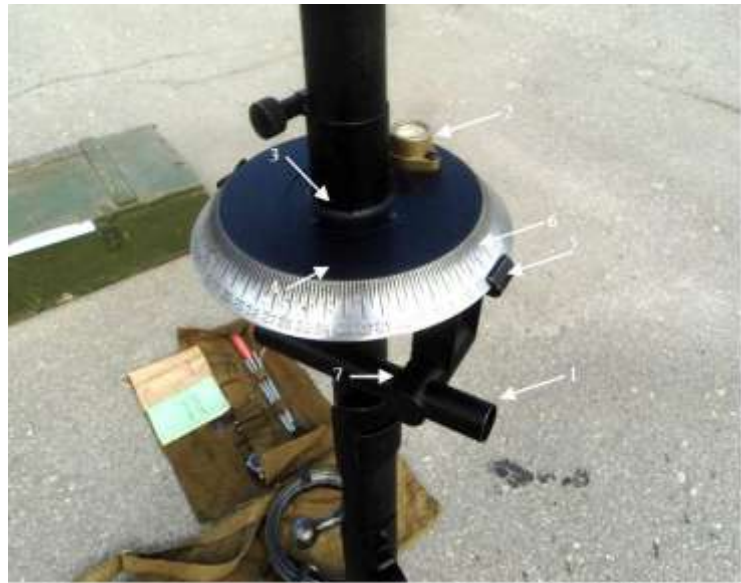
Рисунок 4.15 – Лімб: 1 – візир; 2 – кульовий рівень; 3 – втулка; 4 – лімб; 5 – вказівник; 6 – шкала; 7 – затискний гвинт візира
