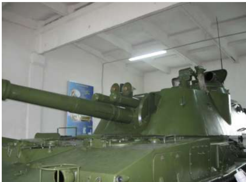
Рисунок 8.5 – Розміщення ПБС на 152-мм самохідній гаубиці СГ 2С3
