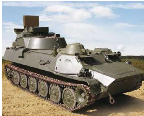
Рисунок 6.15 – Радіолокаційна станція розвідки рухомих цілей СНАР-10 Таблиця 6.8 – Тактико-технічні характеристики радіолокаційної станції СНАР-10
