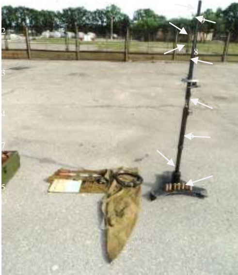
Рисунок 4.14 – Вітрова рушниця ВР-2: 1 – ствол; 2 – візир; 3 – перехідна труба; 4 – стійка; 5 – основа; 6 – кульова п'ята; 7 – важіль; 8 – затвор; 9 – лімб
