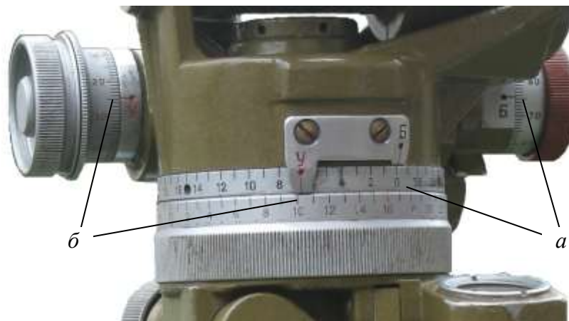
Рисунок 1.15 – Зчитування відліків за шкалами бусолі: а) за бусольною шкалою – 58-75; б) за кутомірною шкалою – 10-25
