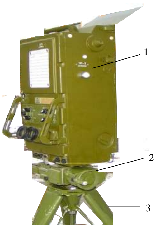
Рисунок 1.30 – Лазерний далекомір-цілевказівник 1Д15: 1 – прийомопередавач; 2 – система наведення; 3 – тринога
