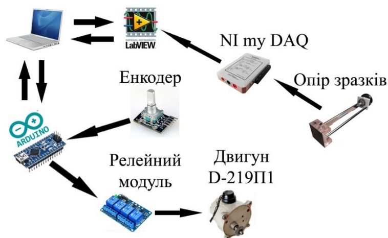
Рисунок 1.10 – Функціональна схема інформаційної система контролю для дослідження тензорезистивних властивостей тонких плівок
