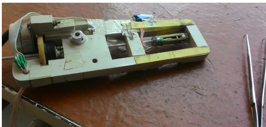
Рисунок 1.16 – Чотирьохконтактний тримач з механізмом повороту
