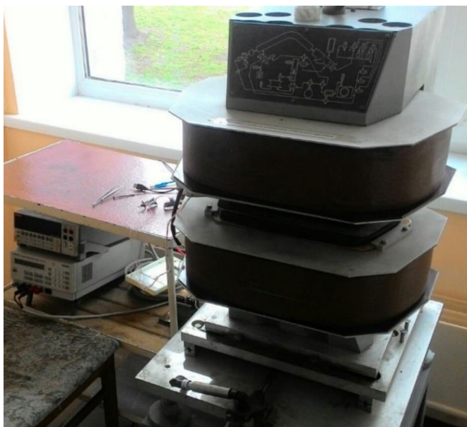
Рисунок 1.15 – Зовнішній вигляд автоматизованого комплексу для дослідження магніторезистивних властивостей
