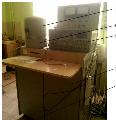
Рисунок 1.7 – Зовнішній вигляд установки ВУП – 5М: 1 – робочий об'єм; 2 – пульт керування; 3 – стійка силова; 4 – вакуумна система; 5 – основа
