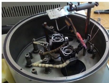
Рисунок 1.8 – Робоча камера ВУП-5М з встановленими двома електронно-променевими гарматами, заслінкою та столиком з підкладками
