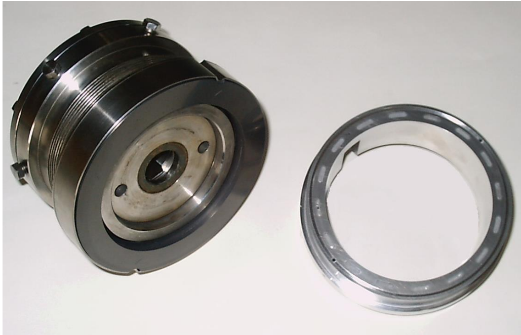
Рисунок 4.10 - Фотографія конструкції запірною імпульсного ущільнення
