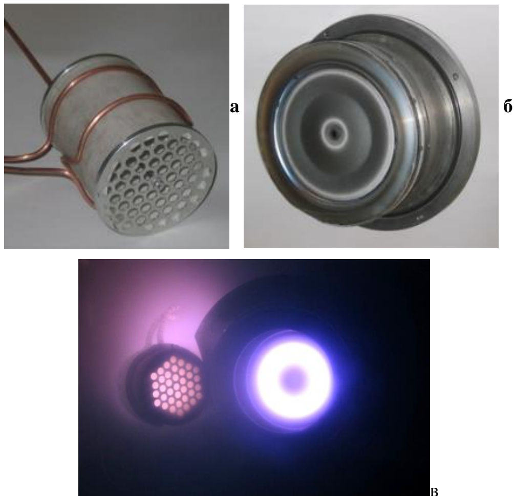
Рисунок 2.2 – Фото джерела ІЧП (а), магнетрону (б) та фотографії всередині камери протягом процесу (в)
