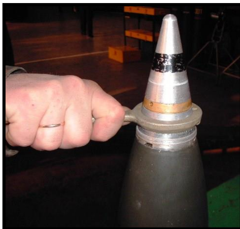
Рисунок 5.8 – Установка підричника Т-7
