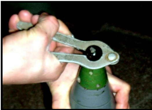
Рисунок 5.5 – Згвинчування ковпачка лещатами
