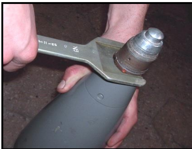
Рисунок 5.30 – Догвинчування підри- вника В-90
