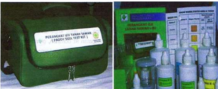
Gambar 8.9 Perangkat Uji Tanah Sawah (PUTS) dengan berbagai reagen kimia
