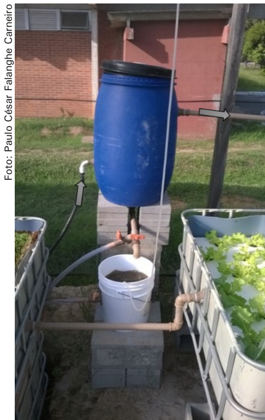
Figura 4. Filtro de sólidos por decantação utilizando um tonel plástico de 200 L. A água que vem do tanque de criação de peixes entra pela parte inferior do tonel e sai pela parte superior (ver setas) para permitir a decantação das fezes. Note balde com fezes coletada da base do decantador sendo mineralizadas pela ação de bactérias aeróbicas.
