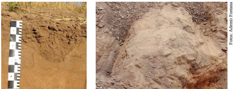
Figura 9. Aspecto no perfil de solo com a camada endurecida preparado para a semeadura de algodão na área de estudo.
