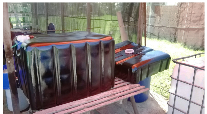
Figura 4. Detalhe das partes plásticas do container IBC logo após a pintura com tinta preta.
