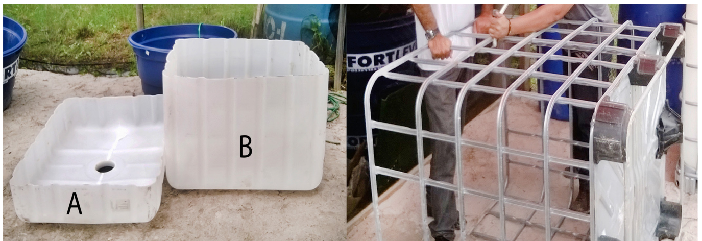
Figura 3. Detalhe do corte do container IBC (recipiente plástico e estrutura metálica) em duas partes, (A) a superior com 20 cm e (B) a inferior com 80 cm.
