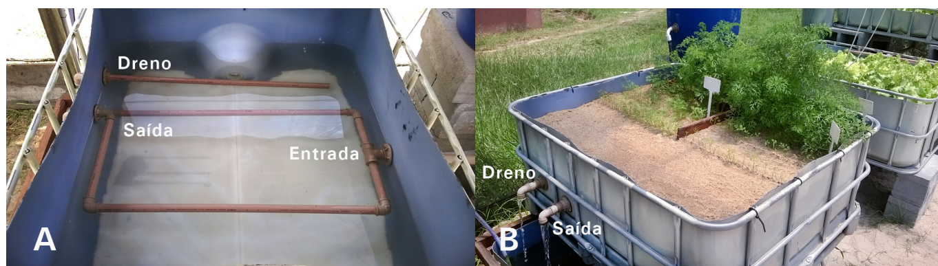
Figura 12. Ambiente de cultivo de raízes tuberosas em areia. (A) Detalhe da instalação das tubulações de passagem e liberação da água e do dreno antes da colocação da areia lavada. (B) Vista externa após plantio de cenoura.
