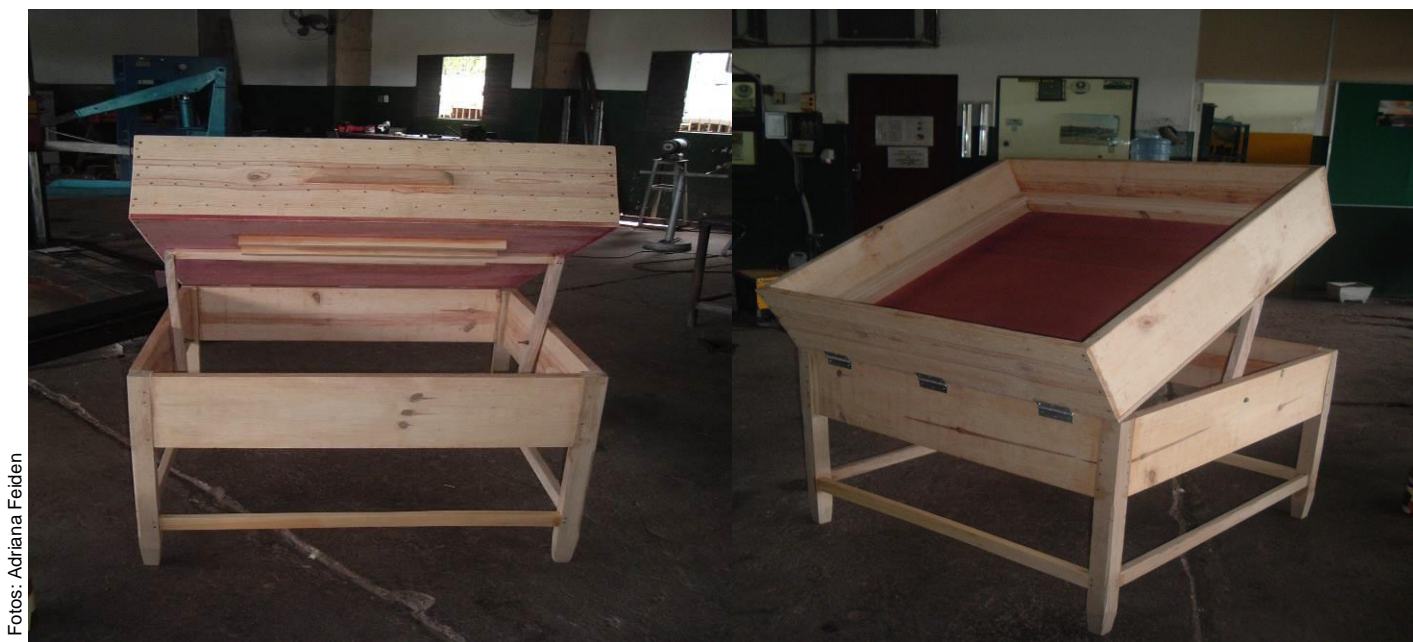
Figura 2. Secador experimental baseado no modelo do IAPAR, ainda sem pintura.
