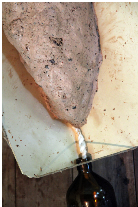
Figura 18. O “pão”, com um furo, colocado em uma biqueira plástica, mostrando um papiro para direcionar o escoamento do óleo até o vidro.
