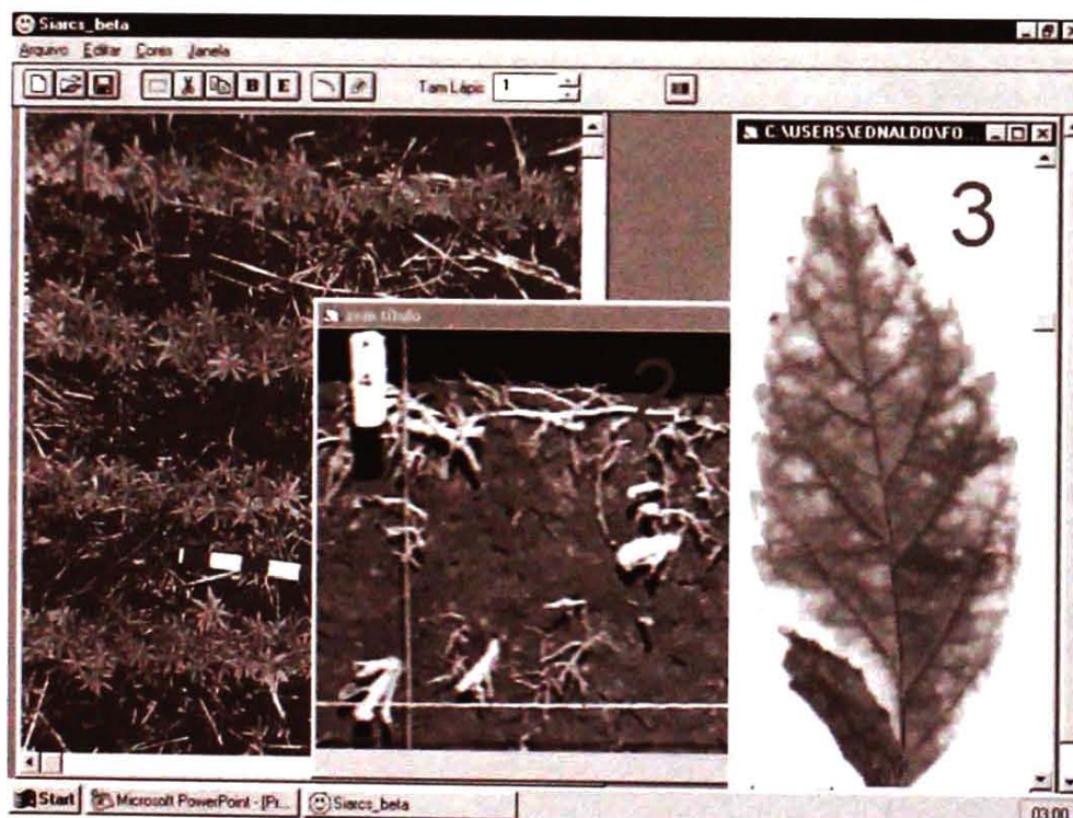
Foto mostrando a tela do computador com imagens digitalizadas, de cobertura vegetal (1), de raízes (2) e de uma folha (3) para análises pelo SIARCS.
