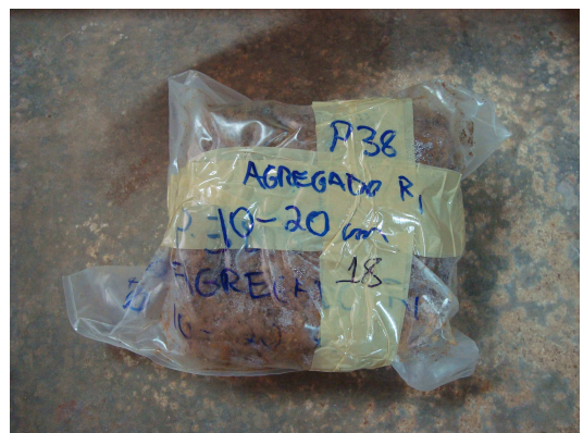
Figura 4. Bloco de solo indeformado acondicionado para evitar danos na estrutura.
