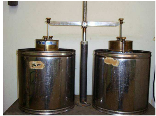
Figura 3. Aparelho de oscilação vertical (Yoder).
