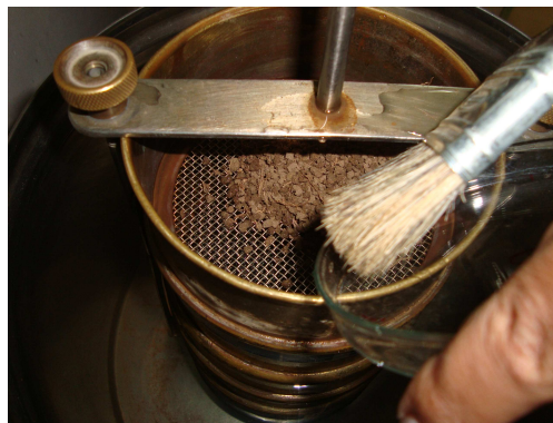
Figura 7. Distribuição dos agregados na primeira peneira, quando o jogo se encontra na sua posição superior máxima.
