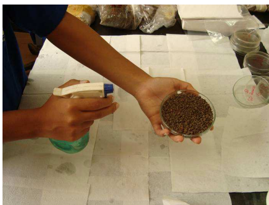
Figura 6. Processo de umedecimento por atomização, mantendo distância da amostra borrifada do atomizador para não causar o rápido umedecimento e a consequente quebra do agregado.
